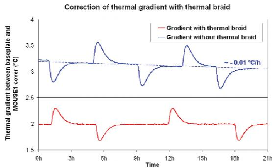
Fig. 10 : Correction of thermal gradient
