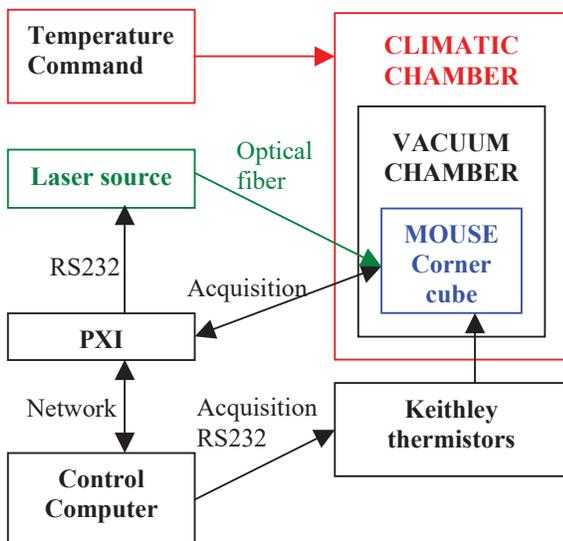
Fig. 7 : test configuration
