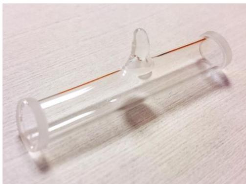
**Fig. 2** : Acetylene gas cell
