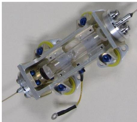
**Fig. 4 :** Gas-Cell Subassembly
